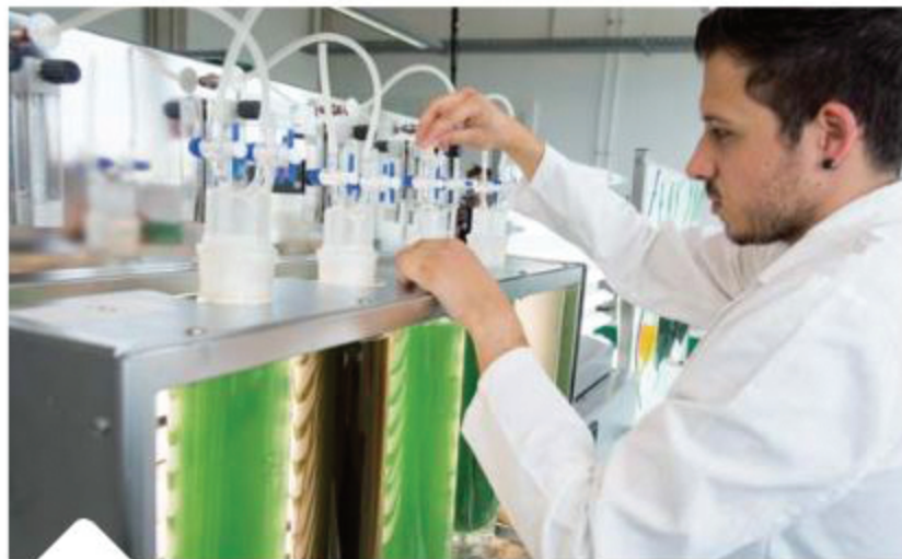
Ces tubes, spécialement développés par Algae Natural Food, permettent de produire de la spiruline à coût abordable.
